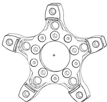
**轉接座** 轉接座和碟盤安裝時務必使用扭力版手，螺絲扭力值為26N-m
