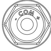
調整避震器壓縮時的油壓，逆時鐘轉到底為第0格。順時鐘旋轉為增加油壓，反之則減弱油壓。
