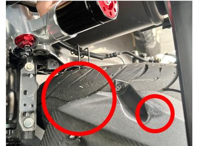
調整工具需自行準備小型5號內六角工具，長邊建議不要超過86mm，短邊建議不要超過32mm，調整時以長邊插入旋鈕並小力旋轉做調整。
