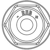
調整避震器伸長時的油壓，逆時鐘轉到底為第0格。順時鐘旋轉為增加油壓，反之則減弱油壓。
