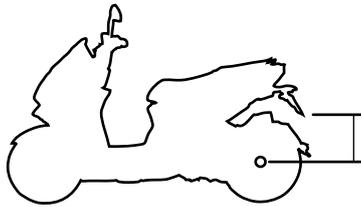
避震器安裝上車後量測車殼到後輪芯的下沉距離。
