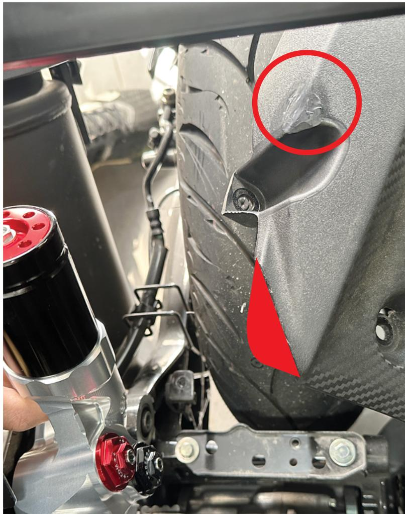
請修除“紅色區塊”中的土除，紅圈處請使用熱風槍適當加溫後將之壓平一部分。
