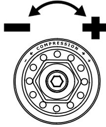
調整避震器壓縮時的油壓，逆時鐘轉到底為第0格。順時鐘旋轉為增加油壓，反之則減弱油壓。
