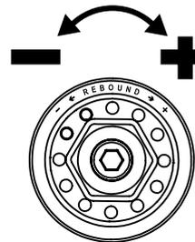
調整避震器伸長時的油壓，逆時鐘轉到底為第0格。順時鐘旋轉為增加油壓，反之則減弱油壓。
